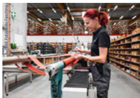
In der hauseigenen Werkstatt fertigen die Fachleute von Haberkorn maßgeschneiderte Riemen an.
